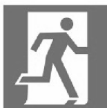
Рисунок 5 - Основа цветографического изображения и соотношение размеров эвакуационных знаков безопасности и знаков безопасности медицинского и санитарного назначения
