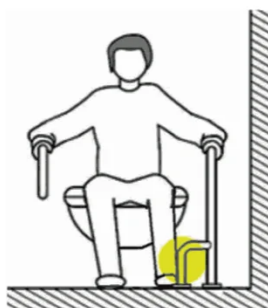
Рисунок А.17 - Опора поручня, создающая помеху при вставании
