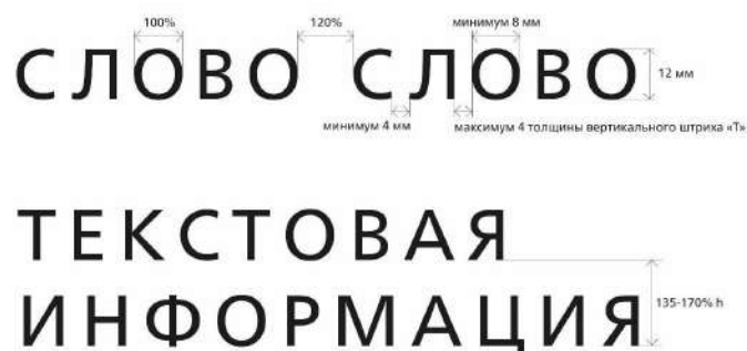
Рисунок 4 - Параметры шрифтовых знаков и рельефа (рифа) РЛШ
