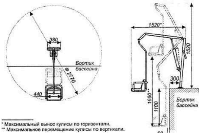
Рисунок Г.10 - Примеры конструкций подъемников для пересадки в ванну и бассейн
