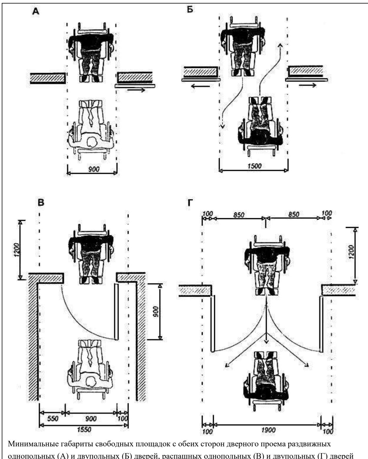
Минимальные габариты свободных площадок с обеих сторон дверного проема раздвижных однопольных (А) и двупольных (Б) дверей, распашных однопольных (В) и двупольных (Г) дверей
