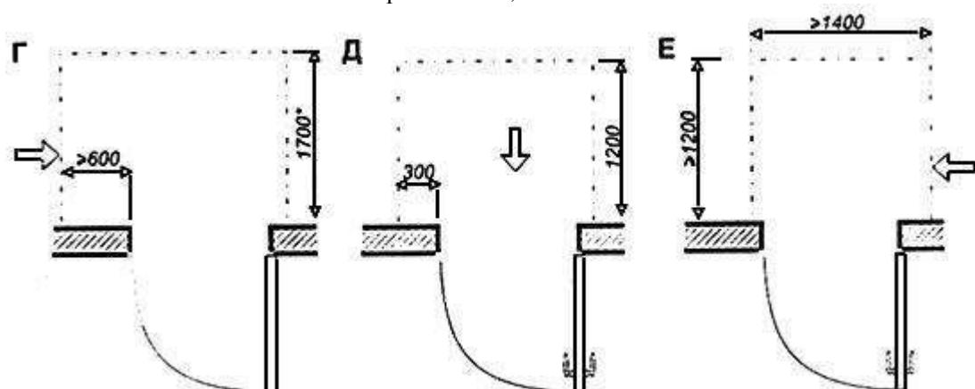
А, Б, Г - двери без запора; В - дверь с закрывателем; Д, Е - двери, имеющие ручку и закрыватель
