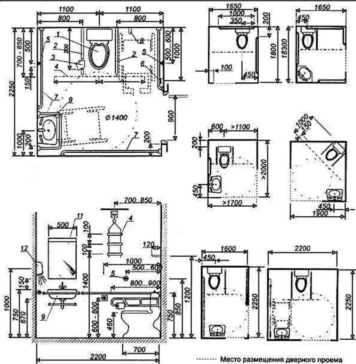
1 - унитаз; 2 - откидывающаяся опора для рук; 3 - бумагодержатель; 4 - штанга с навесными рукоятками; 5 - кнопка слива воды; 6 - кнопка сигнализации; 7 - горизонтальный поручень; 8 - крючок для одежды; 9 - раковина с туалетной палкой; 10 - рычажовый удлинитель крана; 11 - зеркало; 12 - фен
