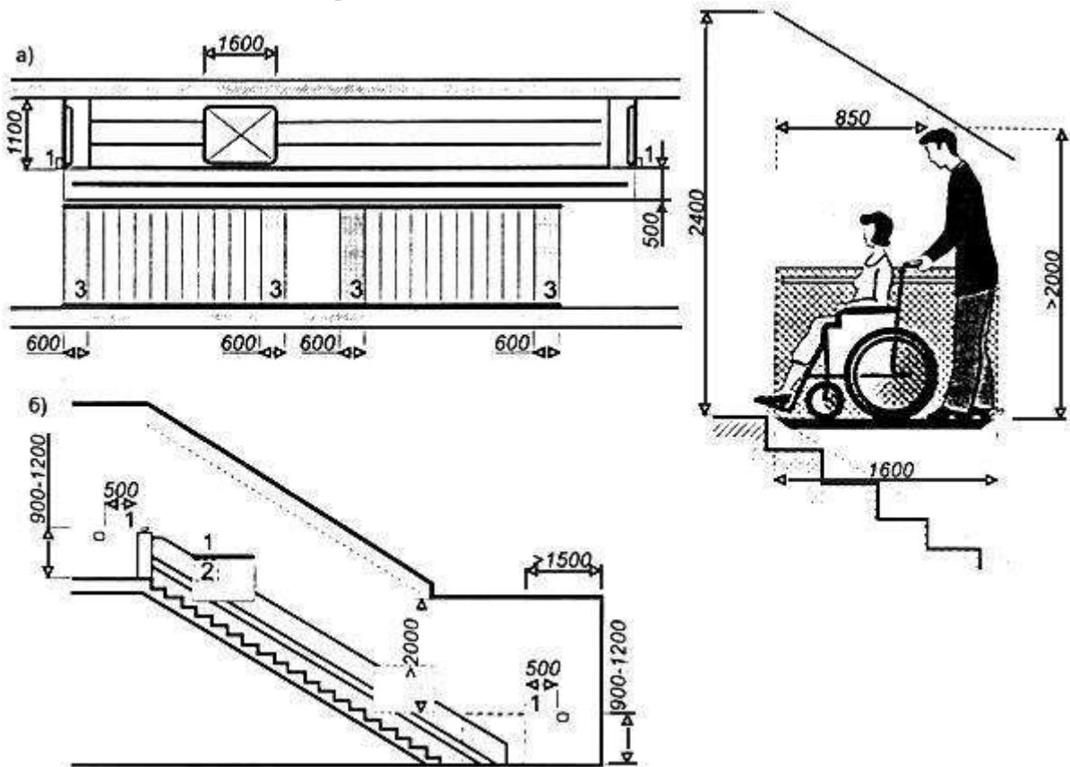
а - перемещение подъемника параллельно лестнице; б - перемещение лестничного подъемника (над ступенями)
