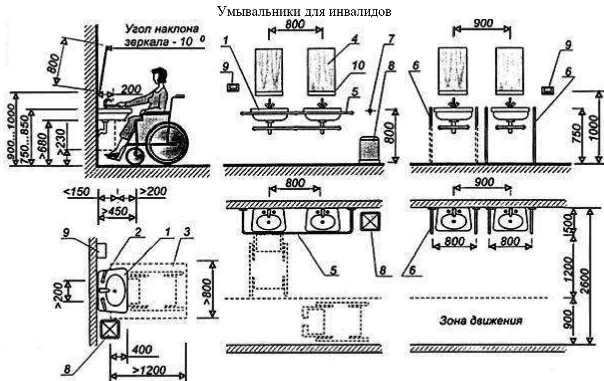
1 - раковина умывальника; 2 - рычаги управления кранами (вариант); 3 - зона кресла-коляски; 4 - зеркало (при наклоне середины зеркала - на высоте 1250 мм); 5 - горизонтальная опора; 6 - откидывающаяся опора-кронштейн; 7 - кнопка управления крышкой бачка; 8 - мусорный бачок; 9 - полотенце (фен); 10 - полка
