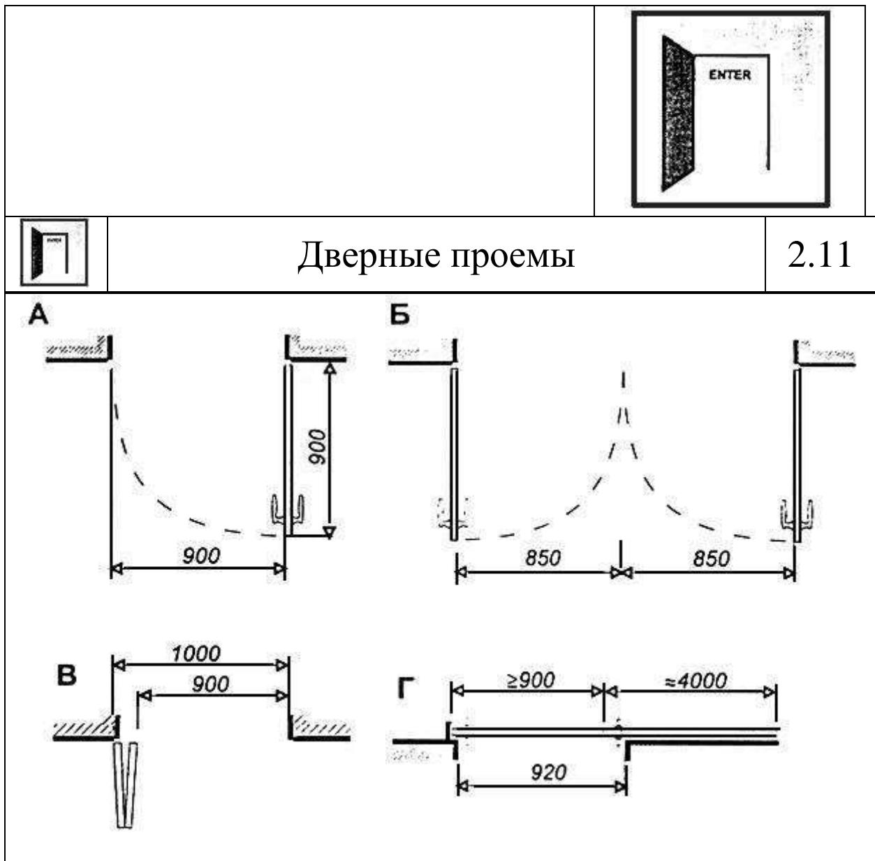
Ширина дверного просвета при различных видах дверей: А - однопольная дверь; Б - двухпольная дверь; В - складная дверь; Г - раздвижная дверь; Д - полуторопольная
