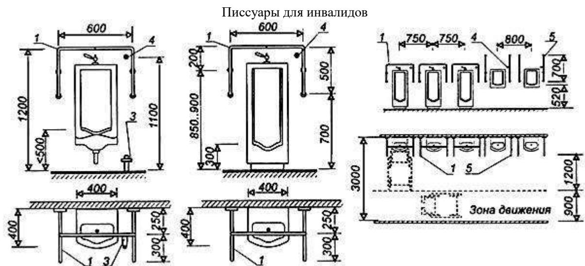
1 - поручни опоры; 2 - смывной кран (ручной); 3 - смывной кран (ножной); 4 - кнопка управления смывом; 5 - опора вертикальная
