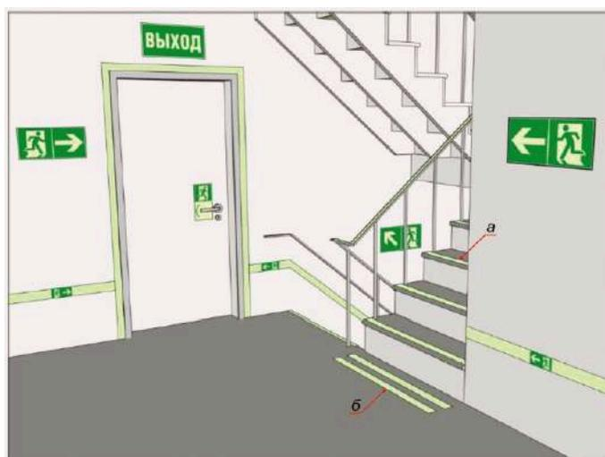
а - обозначение переднего горизонтального края ступеней фотолюминесцентными полосами; б - обозначение окончания лестничного марша двумя параллельными фотолюминесцентными полосами
