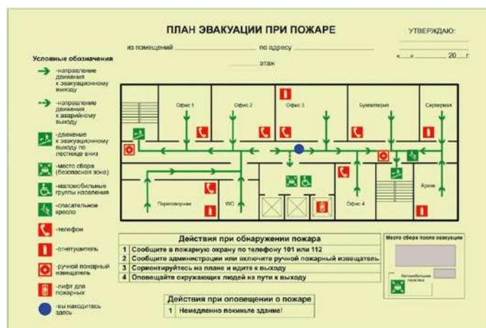
Рисунок 9 - Пример плана эвакуации
