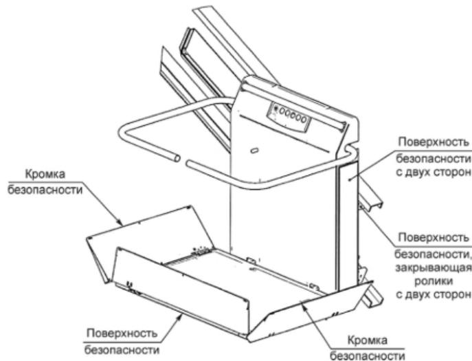
Рисунок 6 - Пример расположения кромок и поверхностей безопасности
