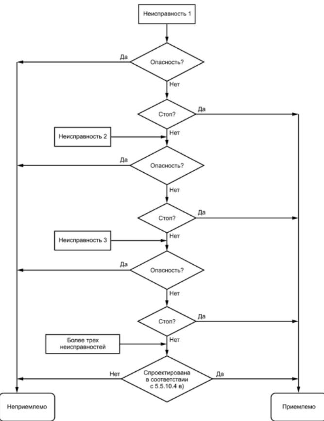
Рисунок 5 - Блок-схема оценки цепи безопасности
