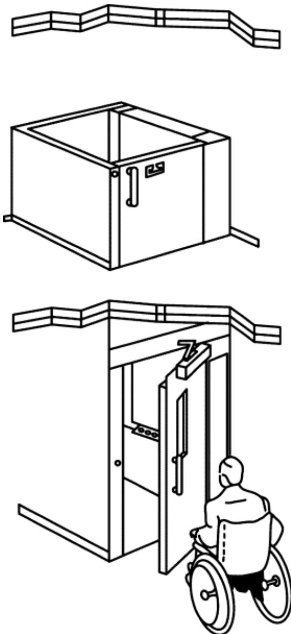
Рисунок 7 - Пример вертикальной платформы с огражденной шахтой
