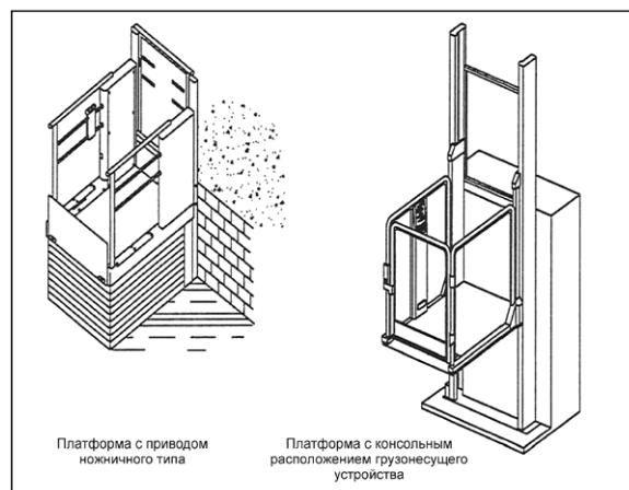
Рисунок 1 — Примеры вертикальных подъемных платформ с неогражденной шахтой
