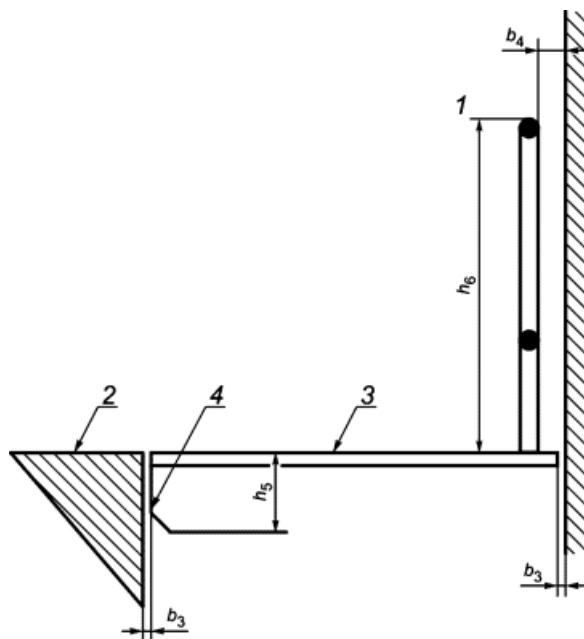
1 - защитные устройства, требуемые, если  $b_4$  менее 100 мм;
