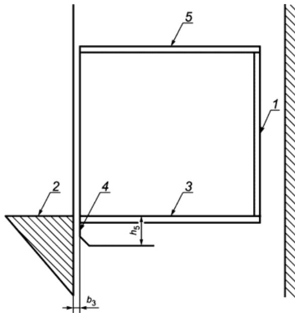
1 - ограждение грузонесущего устройства;
