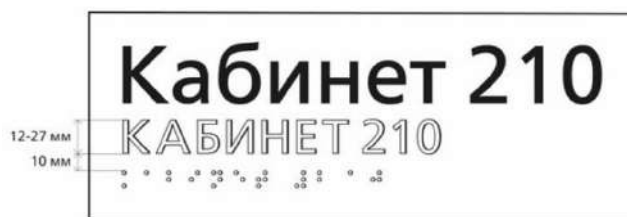
Рисунок 32 — Высота РЛШ при сочетании с плоскочечатным шрифтом (в данном случае знаки РЛШ и РТШ рекомендуется выполнять прозрачными или в цвет подложки)
