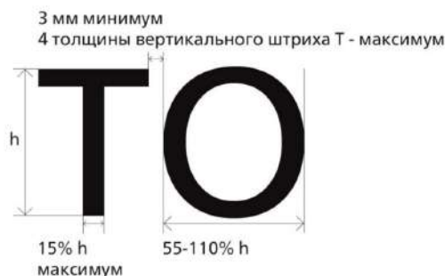
Рисунок 24 — Пропорциональные соотношения элементов шрифтовых знаков
