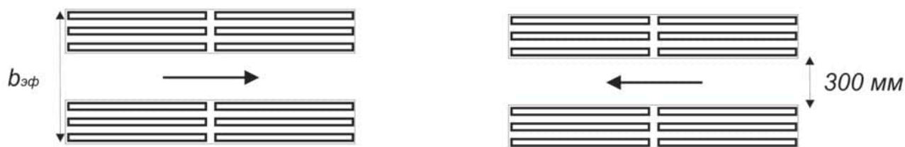
Рисунок А.6 — Форма рифления — прямолинейные параллельные рифы с плоской вершиной (6 шт.), используемые для обустройства направляющего указателя для движения в одном направлении
