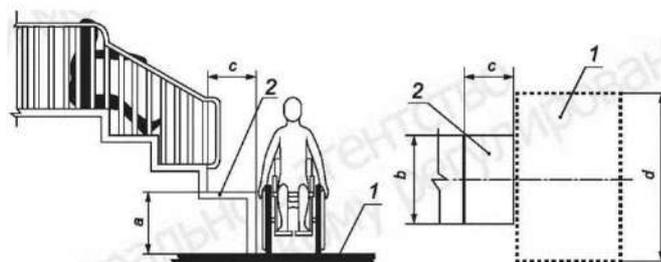
1 — парковка для колясок на уровне поверхности универсальной игровой площадки; 2 — трансферная платформа;  $a$  — высота до верхней поверхности трансферной платформы;  $b$  — длина платформы;  $c$  — ширина трансферной платформы;  $d$  — длинная сторона «парковки для кресел-колясок»
