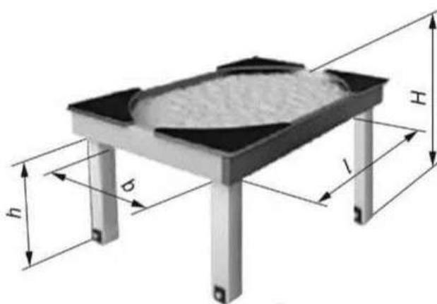
$H$  — высота игровой поверхности стола;  $h$  — высота пространства для коленей;  $l$  — глубина пространства для коленей;  $b$  — ширина игровой поверхности стола
