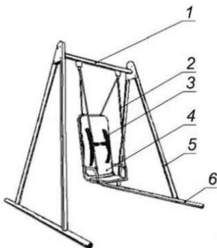
1 — балка; 2 — цепь; 3 — ремни безопасности; 4 — сиденье со спинкой; 5 — стойка; 6 — опора
