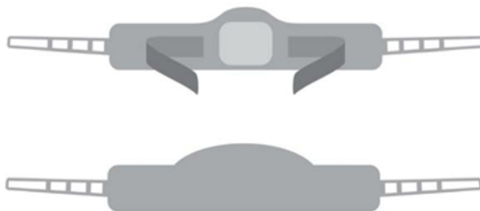
Рисунок С.9 — Пример подвесов для мобильных подъемников для перемещения человека в положении стоя
