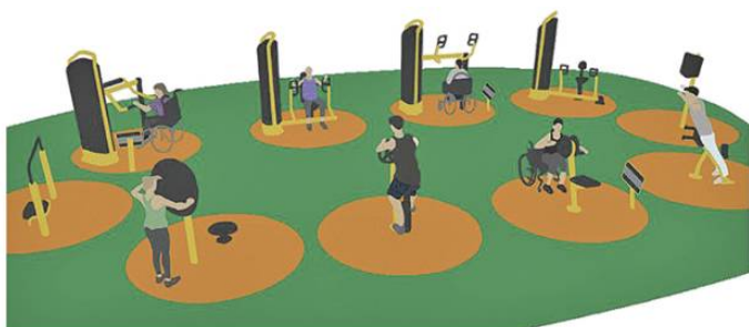
Рисунок А.1 - Пример визуального выделения зоны безопасности оборудования
