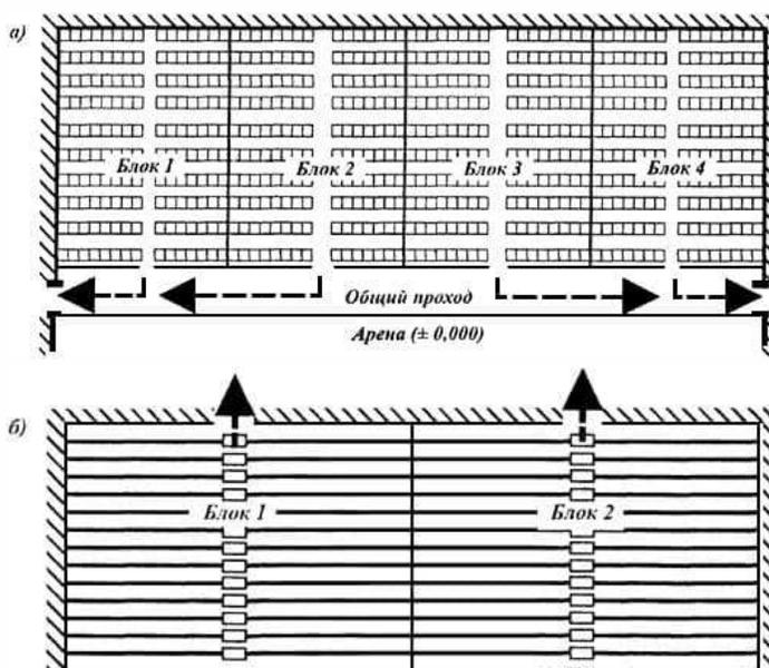
а - при эвакуации в общий горизонтальный проход на уровне арены; б - при эвакуации вверх через дверной проем или на горизонтальный участок
