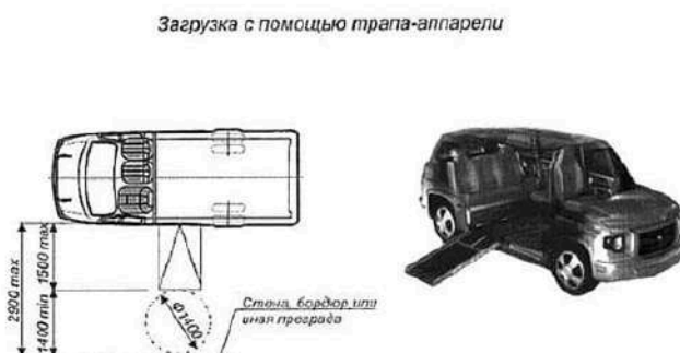
Рисунок В.10 - Параметры зоны посадки-высадки из автотранспорта инвалида на кресле-коляске
