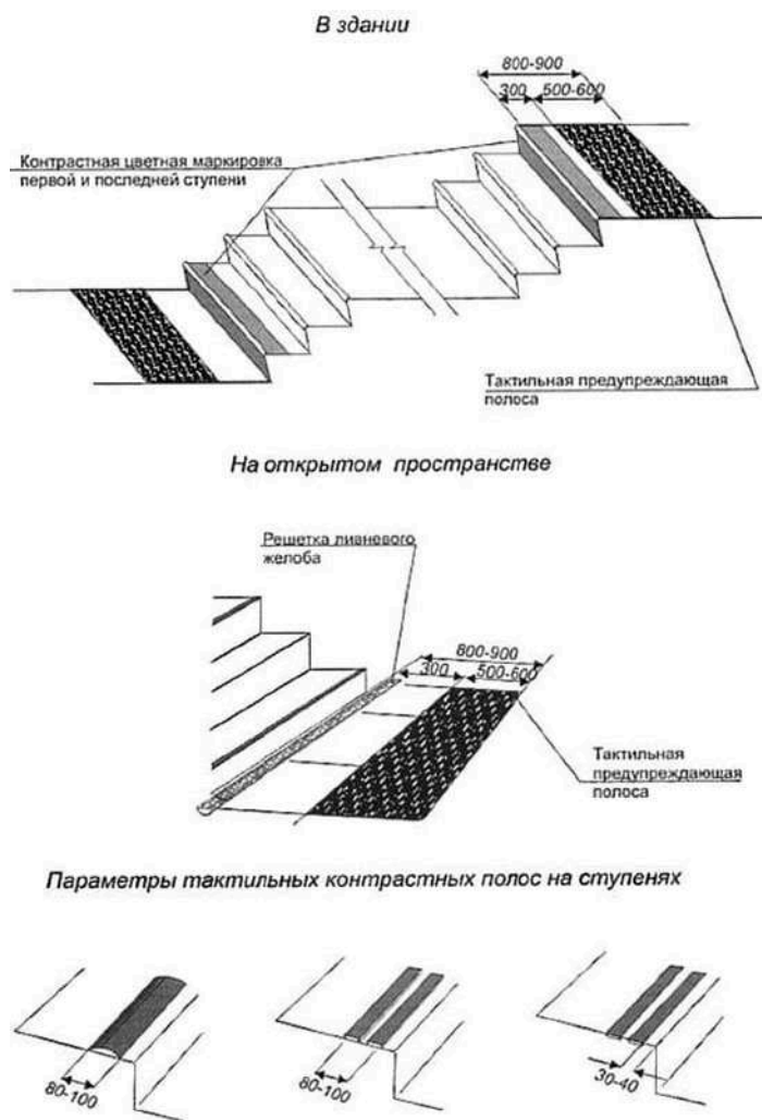
Рисунок В.22 - Предупреждающие контрастные и тактильные полосы
