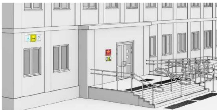
**Рисунок 2** — Пример размещения свето-звукового маяка на фасаде здания на высоте 4,5 м для обозначения доступности объекта
