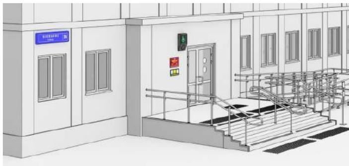
**Рисунок 1** — Пример размещения свето-звукового маяка рядом с дверью входной группы для обозначения доступности объекта и дополнительной информации о его назначении
