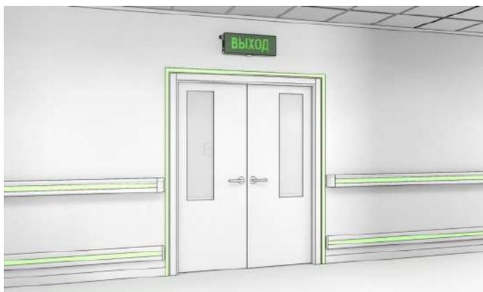
**Рисунок 4** — Пример размещения над дверью свето-звукового маяка для обозначения эвакуационного выхода
