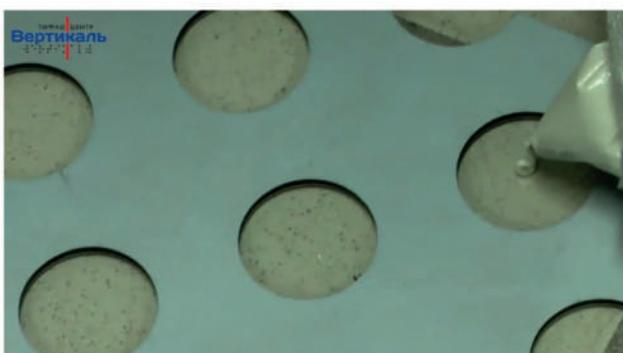
5. Выдавливаем небольшое количество клея из кулька в центр ячейки специального трафарета для укладки.
