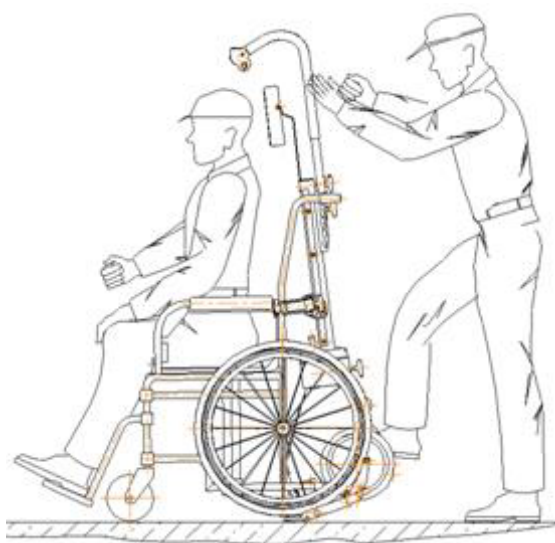
Рис.7. Установка кресла-коляски на подъемник
