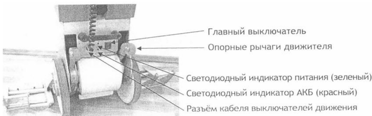
Рис.6. Элементы системы управления
